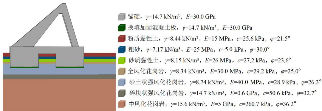
图 7 原型锚碇数值模型 Fig. 7 Numerical model of the prototype anchorage
