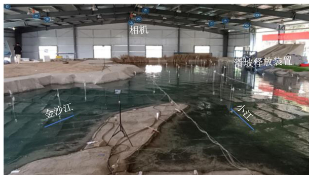
图 4 大型三维王家山滑坡涌浪物理模型试验场
