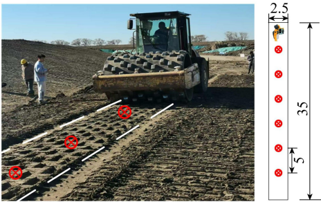
图 1 现场试验布置(单位:m)
