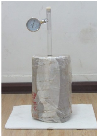
图 7 张力计法测基质吸力
