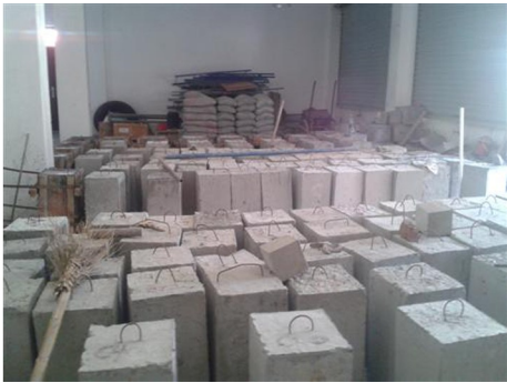
图1 不同强度等级的混凝土试块
