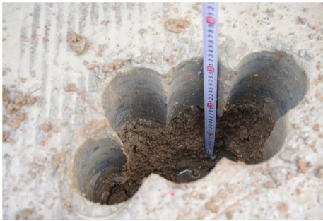
图7 碎石垫层厚度较薄
