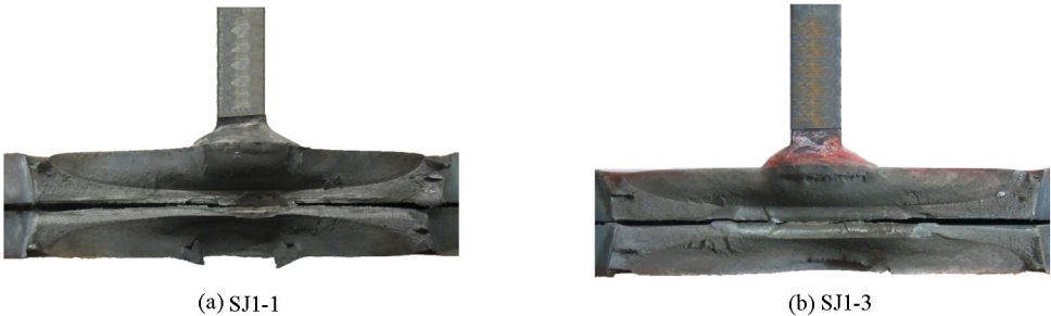
图 6 典型疲劳破坏断面 Fig. 6 Cross-sections of typical fatigue fractures
