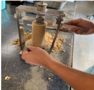
图 5 试验土样制备
