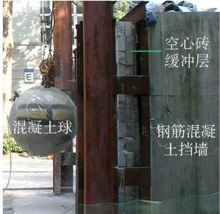
图 1 摆锤冲击装置 Fig.1 Pendulum impact device
