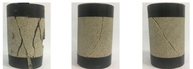
(a) 围压为 0 MPa (b) 围压为 5 MPa (c) 围压为 10 MPa
