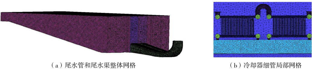
图 2 尾水管和尾水渠整体网格及冷却器细管局部网格放大图
