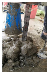
图5 泡沫改良砂卵石的离析现象
