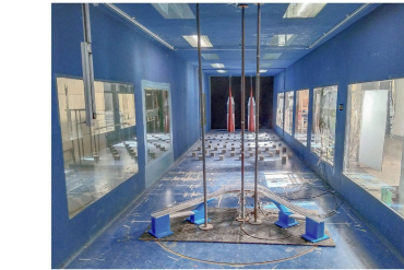
(a) 紊流场中的气弹模型
