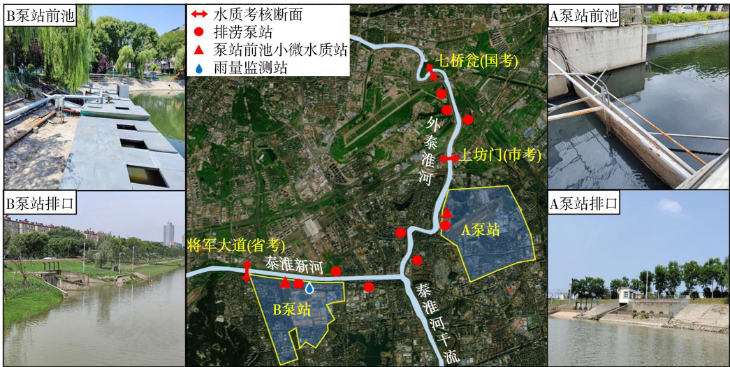
图1 排涝泵站现场及位置
