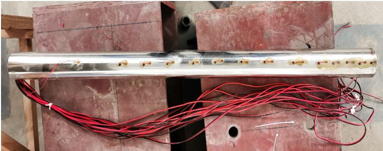
图 2 模型桩桩身应变片布置
