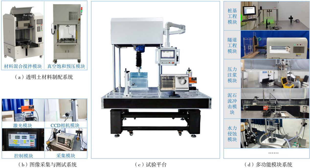
图 1 多功能透明土模型试验系统装置
