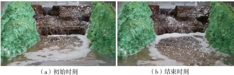
图 10 加速冲蚀阶段 Fig. 10 Accelerated scour stage
