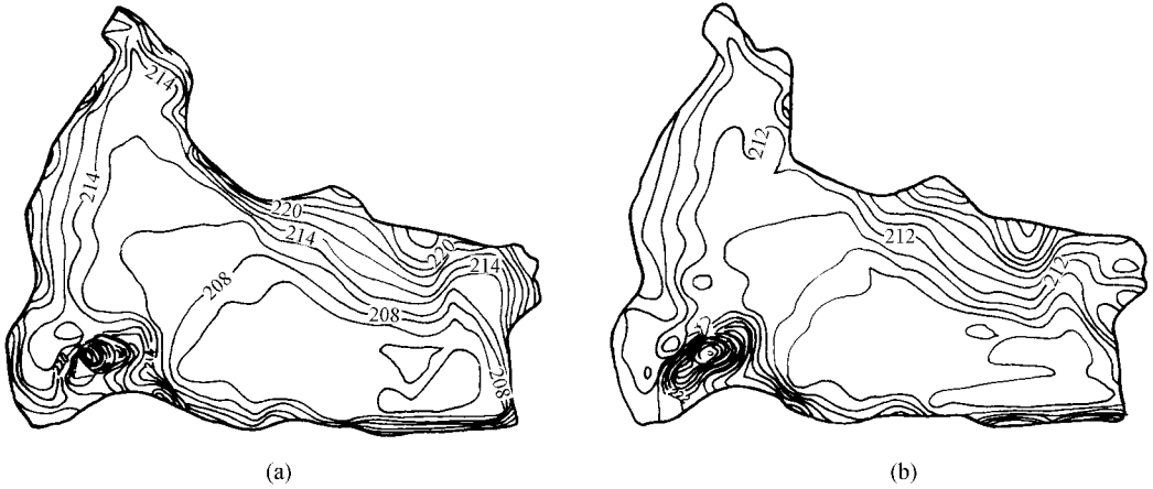
图 5 白沙水库 1987 年河床地形 Fig.5 Bed elevation of reservoir in 1987
