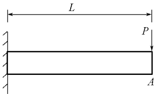
图 1 悬臂梁结构 Fig.1 Cantilever beam
