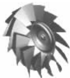
图5 整体叶轮加工实例
