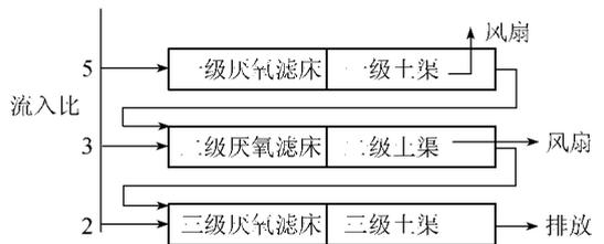
图3 无循环厌氧/好氧土壤处理系统流程
