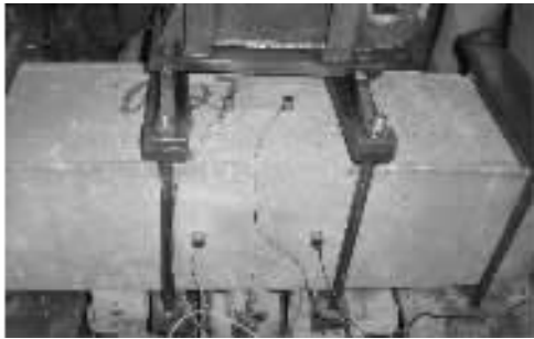
图 5 压电传感器位置 Fig.5 Location of piezoelectric cell
