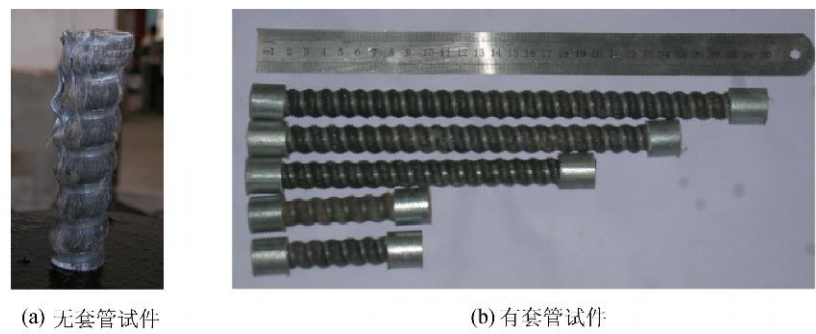
图 1 受压试件类型 Fig.1 Type of compression specimens
