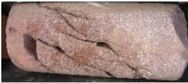
图 4 钻孔 164 深度 65 m 处沿陡倾角裂隙发生的溶蚀现象
