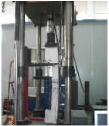
图 3 加载设备原图 Fig. 3 Loading equipment for RC columns
