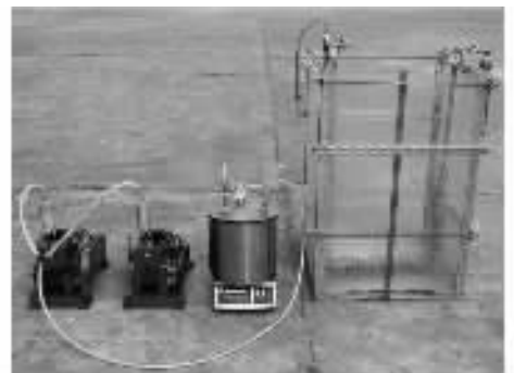
图 1 透气真空排水试验装置全貌
