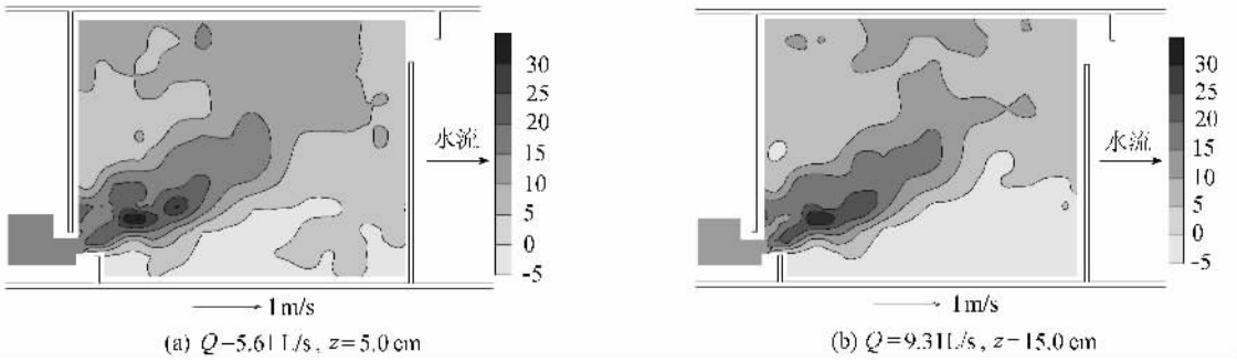
图 9 不同水深等雷诺剪切应力云图(单位: \text{cm}^2/\text{s}^2 )
