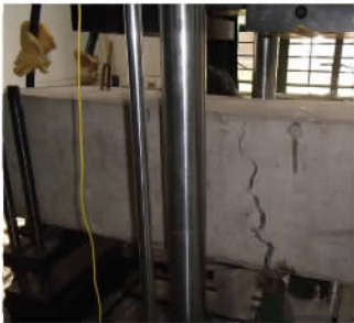
(b)试验破坏裂缝
