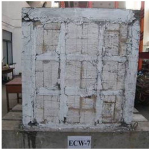
图 3 ECW-7 最终破坏 Fig. 3 Final failure of ECW-7
