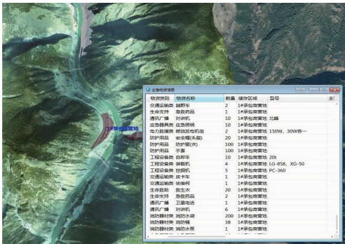
图 10 施工应急物资交互式查询分析界面 Fig. 10 Interactive query interface of emergency materials
