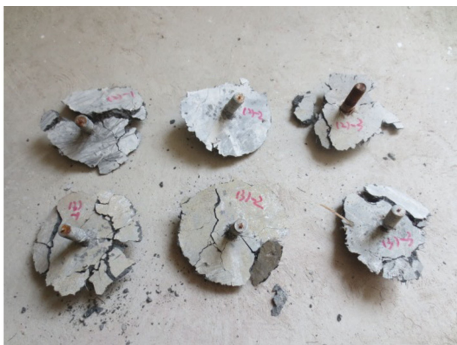
图1 先装拔出法破坏形态(C120)
