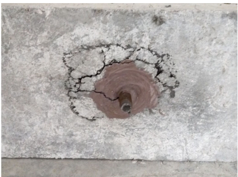
图2 后装拔出法破坏形态(C180)
