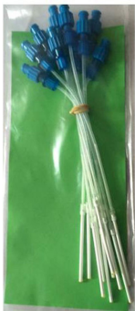
图 2 Rhizon-SMS 土壤溶液采样器 Fig. 2 Soil solution sampler
