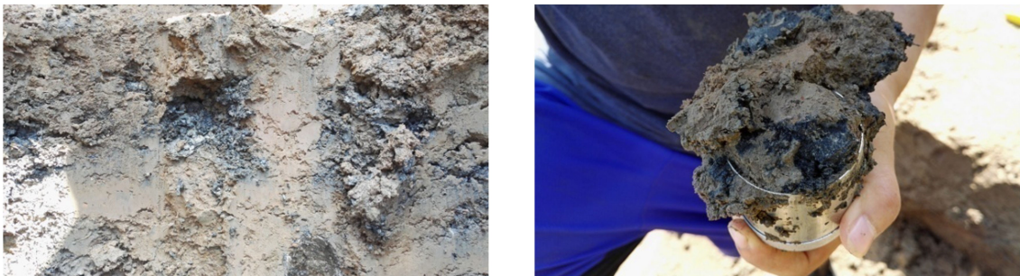
(a) 探槽揭露地下孔隙充填情况 (b) 充填后的土样
