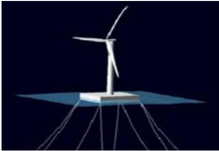
图 1 Barge 浮式平台示意图 Fig. 1 Diagram of Barge platform
