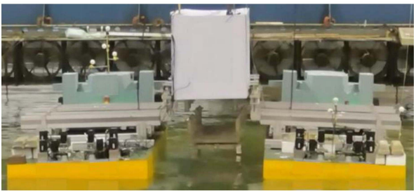
图 4 双船举升作业模型试验
