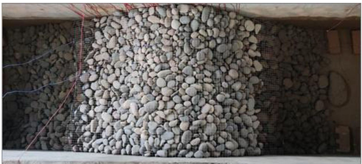
图 1 水下抛石体物理模型 Fig. 1 Physical model of underwater riprap
