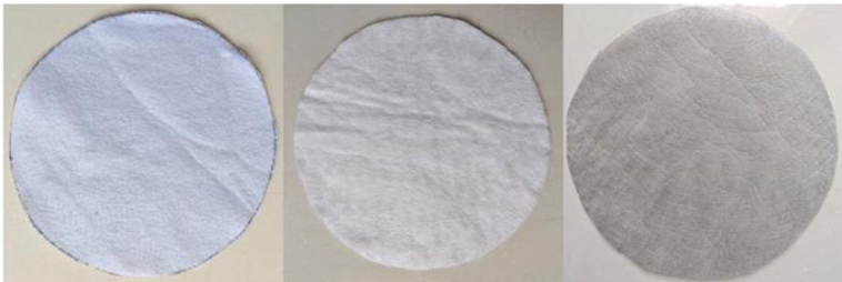
(a) 短纤土工织物 (b) 长丝土工织物 (c) 滤布土工织物
