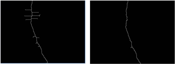
(a) 初步骨架提取 (b) 去除伪分支
