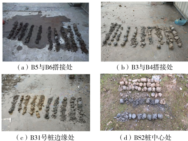
图4 第一次高压旋喷桩试桩取芯情况
