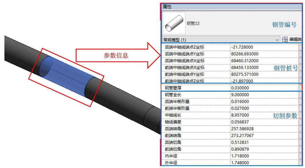
图4 集成设计和施工参数信息的钢管 BIM 模型示意图
