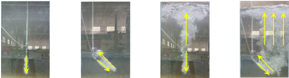
图 3 喷嘴垂直向下排气时羽流运动过程
