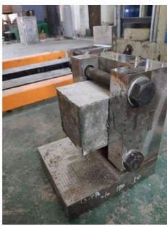
图 2 双 L 直剪试验装置成品
