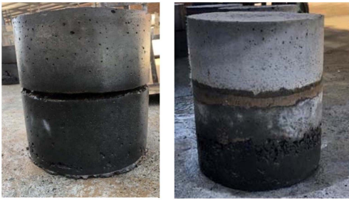
(a) 浇筑成型后的试样 (b) 预留剪切缝
