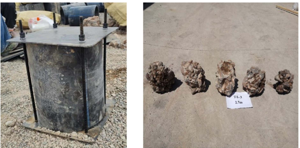
(a) 封装试桶 (b) 胶结砂砾石原状样
