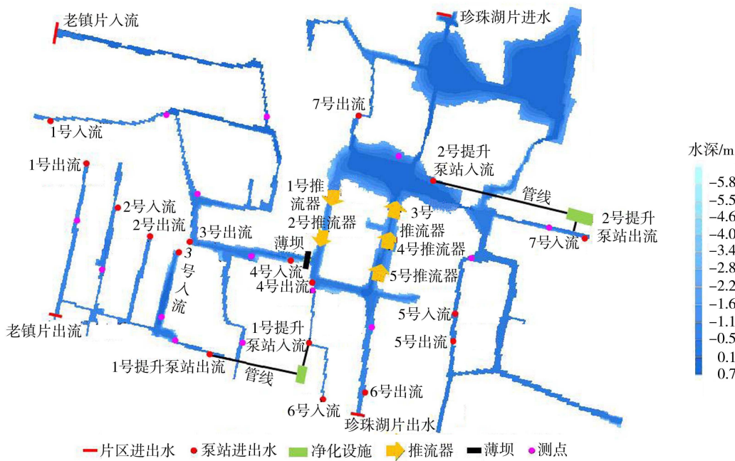
图3 模型边界条件、源汇项与测点设置
