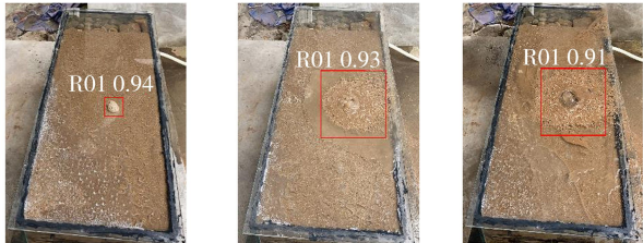
图6 管涌 ROI 范围及置信度
