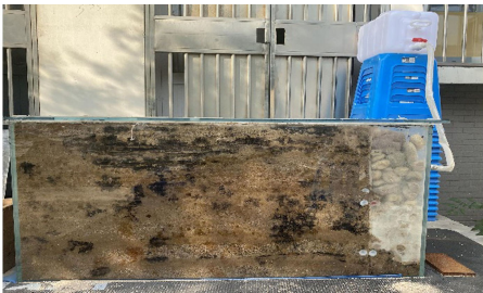
图5 管涌渗漏试验平台
