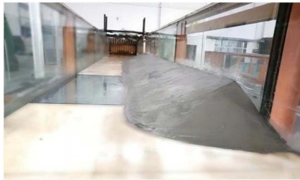
图4 概化边坡(边坡坡度1:3)
