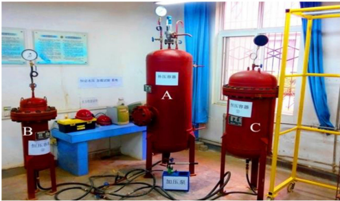
图 1 高渗透水压力加载试验系统
