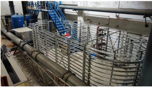
图 1 输水系统水锤试验布置
