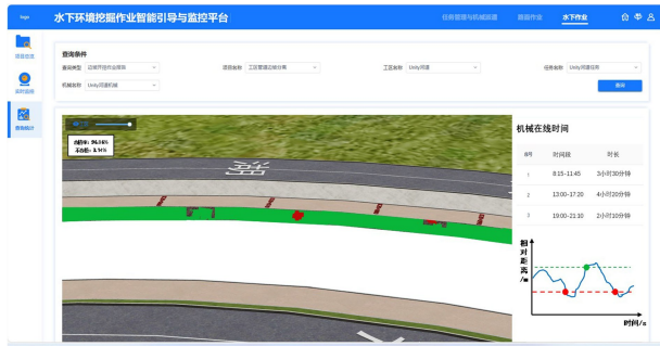
图 11 岸坡开挖质量系统界面
