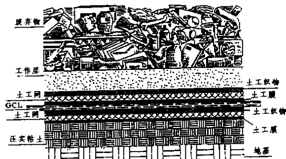
图 12 带有土工合成材料粘土衬垫 (GCL) 的双层复合衬垫
